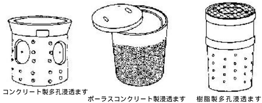
図3 - 4 浸透ますの構造(例)
