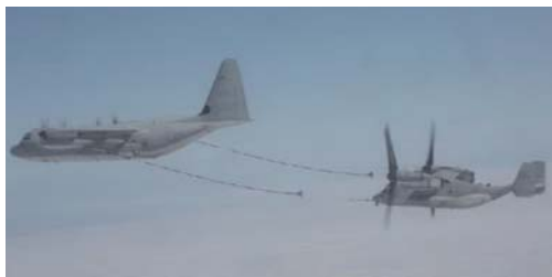
▲KC-130から給油を受けるオスプレイ (米海兵隊ホームページ)
