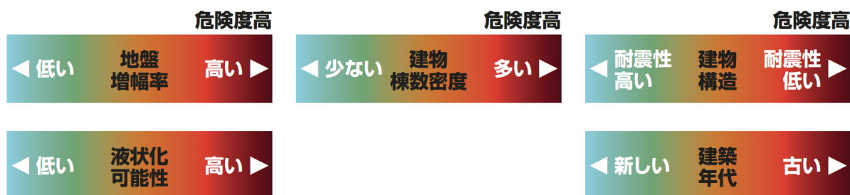
建物倒壊危険度の算出項目
