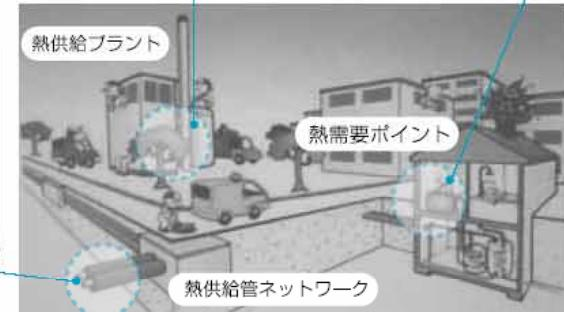
熱供給プラントのボイラーで作られた熱は、地中に張り巡らされたパイプにお湯を通すなどして、熱需要ポイント（家庭や事業所など）に供給される。パイプは断熱材に包まれた2本の管（断面写真）の、1本はお湯（熱）の供給用、もう一本は熱を使い終えたぬるま湯を戻すような仕組みになっている。
